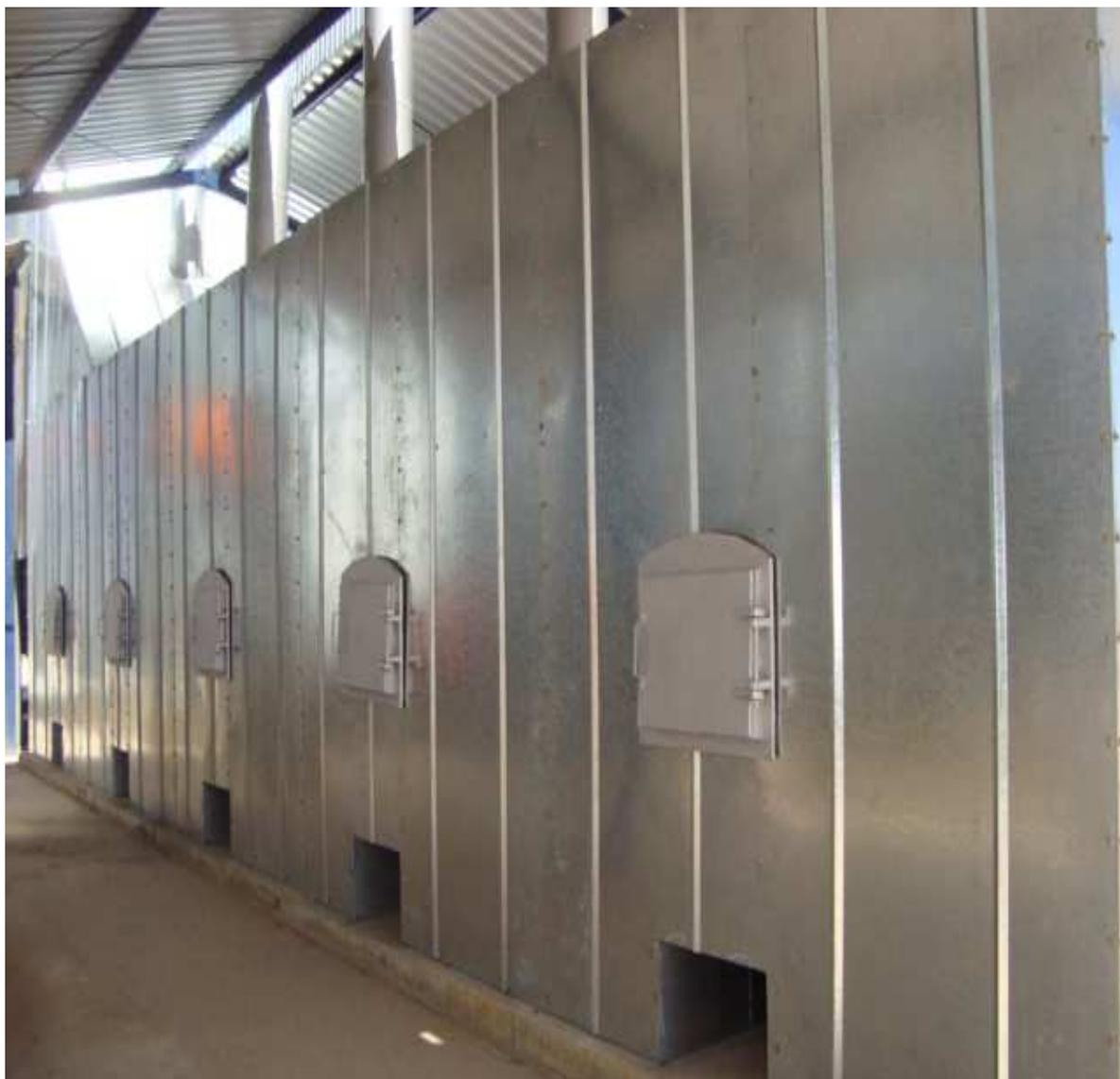
SISTEMA DE AQUECIMENTO DO FLUXO DE AR DE SECAGEM, ATRAVÉS DE SETORES DE AQUECIMENTO INDIRETO EM ALTAS TEMPERATURAS, CIRCULAÇÃO EM TODOS OS SETORES SECUNDÁRIOS DO SISTEMA PARA APROVEITAMENTO TÉRMICO, SECAGEM SEGURA DE FOGO INDIRETO PARA TODOS OS TIPOS DE GRÃOS.
